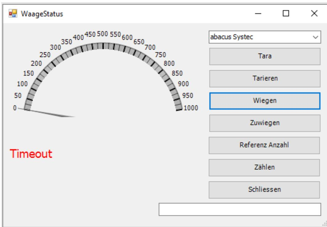
Das Formular <Waagen-Status> dient zum Test der Anbindung der Waage. Es ist aufrufbar über <Waage> <Waagenstamm> <Schaltfläche Waagen-Status>.
